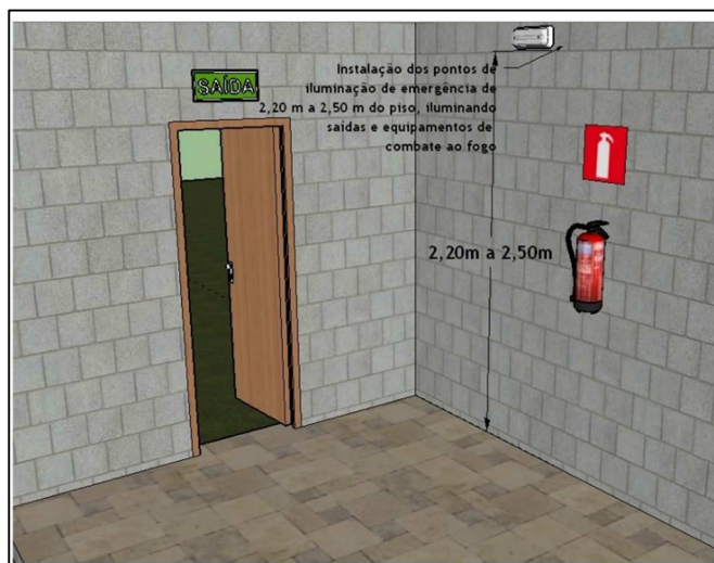
Figura 12 - Instalação dos pontos de iluminação de emergência
