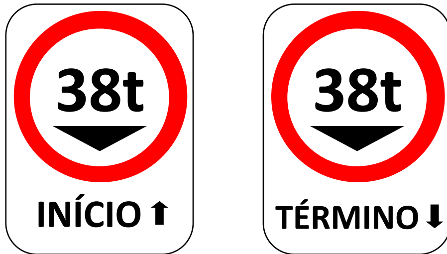
Figura 2 – Sinalização de via de acesso para viaturas sobre subsolo, galeria e similar
