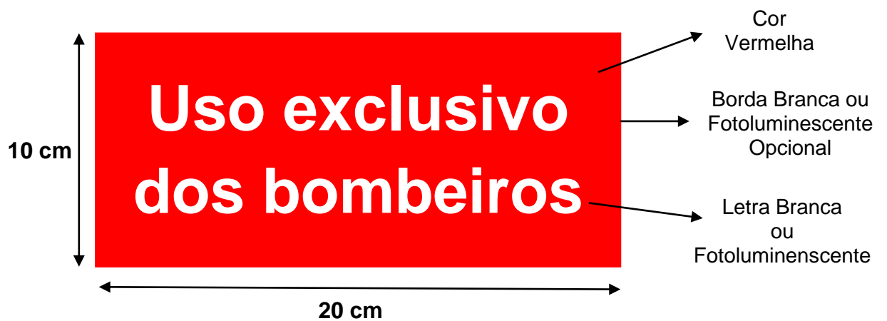
Figura 5 – Sinalização de janela e ponto de ancoragem
