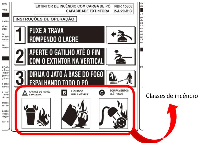
Figura 26 - Classes de incêndio no quadro de instruções do extintor
