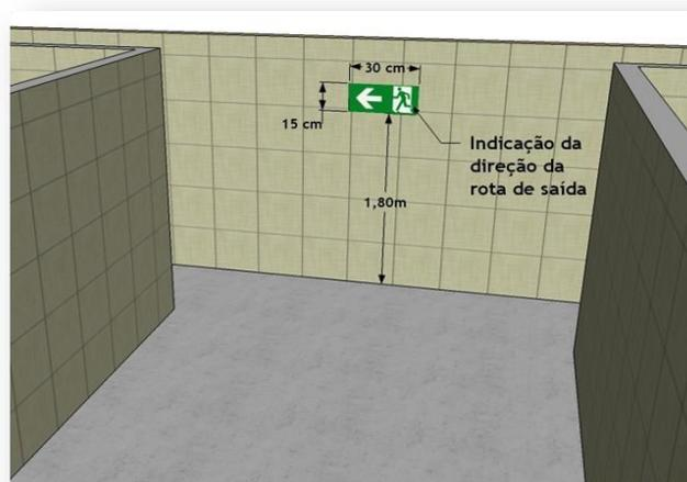
Figura 42 - Indicação da direção da rota de saída
