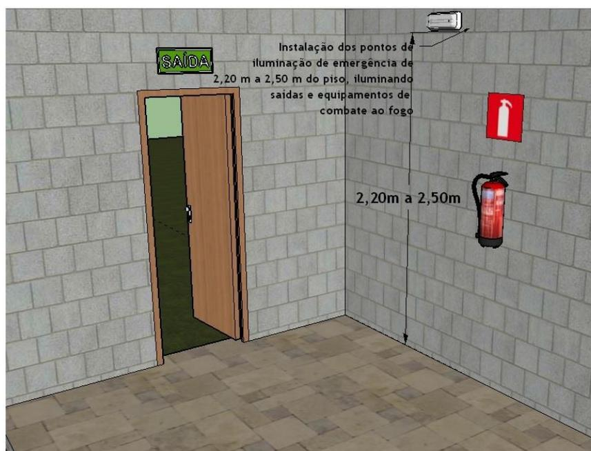
*Figura 48 - Instalação dos pontos de iluminação de emergência*
