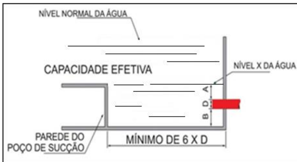
Figura 14: Tomada lateral de sucção para bomba principal
