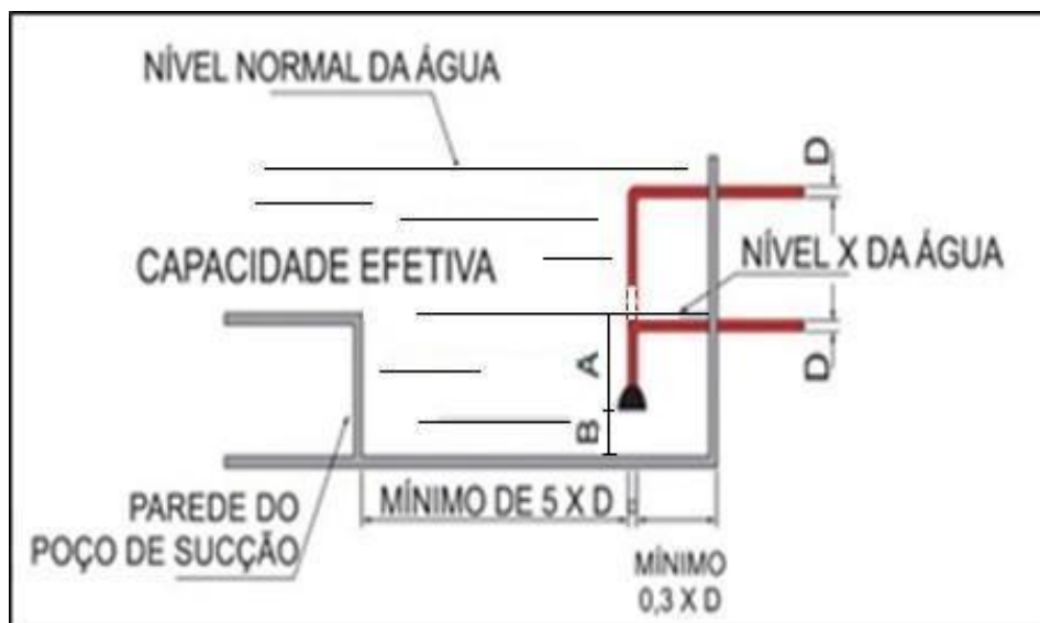
Figura 15: Tomada superior de sucção para bomba principal
