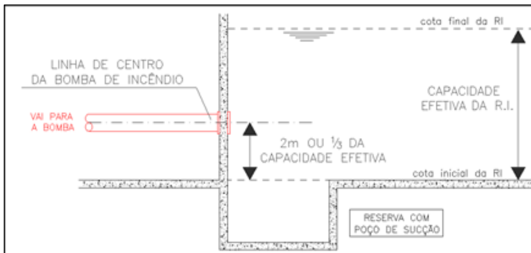
Figura 5: Condição positiva de sucção da bomba de incêndio
